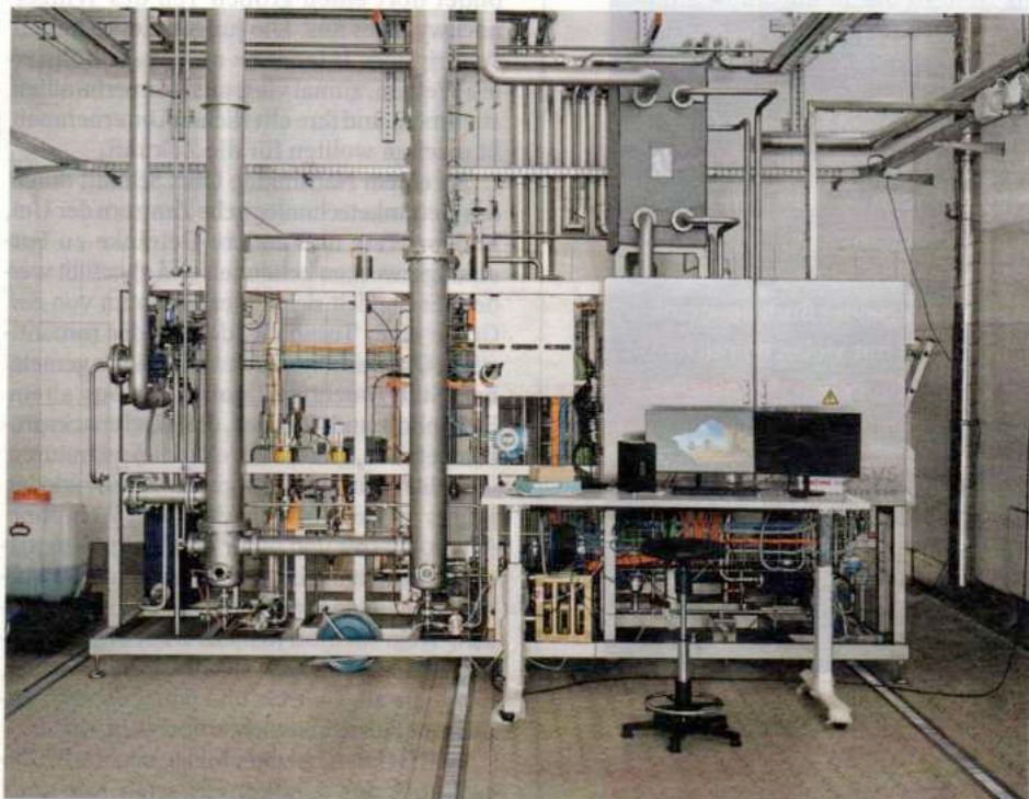
Anlage zur Vakuumdestillation in Geisenheim: Ungleich komplexer, teurer und energieintensiver
